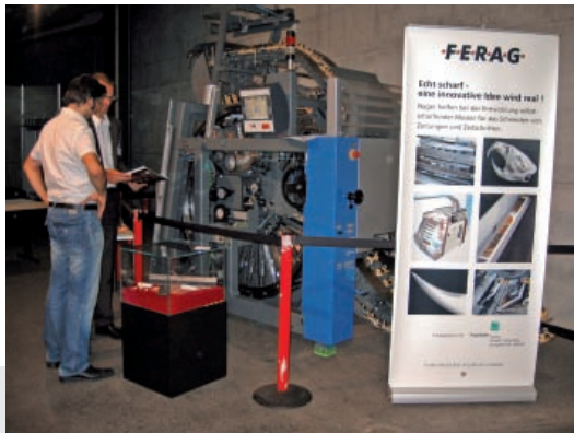
Schneidtrommel für das Zuschneiden von Druckerzeugnissen (Präsentation im Rahmen des BMBF-Bionik-Wettbewerbs 2007 in Berlin)
