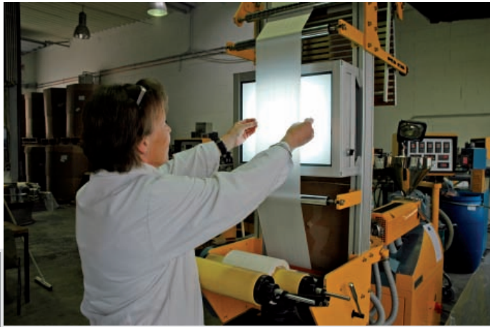
Herstellung einer Blasfolie aus dem Compound
