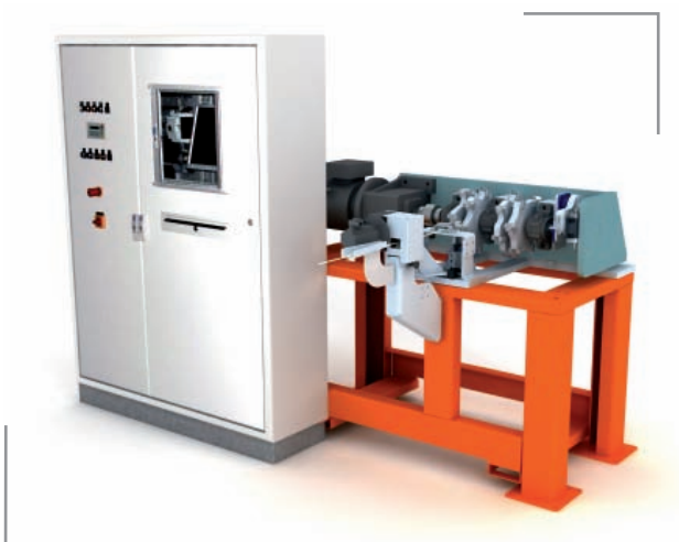
Versuchsanlage für den kontrollierten Verschleiß von Schneidwerkzeugen
